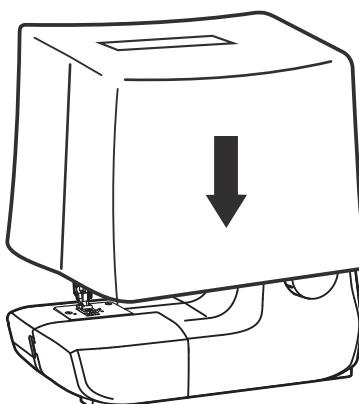
Σε περίπτωση μη χρήσης της ραπτομηχανής, τραβάτε πάντα το βύσμα του καλωδίου τροφοδοσίας. Χρησιμοποιείτε το απεσταλμένο κάλυμμα προστασίας από σκόνη (t). Φυλάτε τη ραπτομηχανή σε στεγανό και μη προσβάσιμο σημείο για παιδιά. Εάν δε χρησιμοποιείτε τη ραπτομηχανή για μεγαλύτερο χρονικό διάστημα, πρέπει να την προστατεύετε από υπερβολική σκόνη, ακαθαρσίες ή υγρασία.
