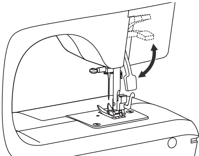
Για ράψιμο πολλών στρωμάτων υφάσματος ή χοντρών υφασμάτων, μπορείτε να σηκώσετε το πόδι στριφώματος και να διευκολύνετε την δίοδο του υφάσματος, σταθεροποιώντας το σε μια δεύτερη εγκοπή (18). (Βέλος)
