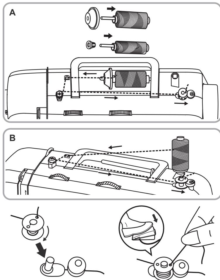
A. Τοποθετήστε τον καρούλι (m) στο στήριγμα κουβαρίστρας (15) και στερεώστε με το καπάκι νήματος (r).
